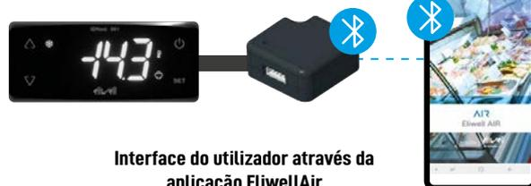
Interface do utilizador através da aplicação EliwellAir
