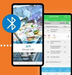
Eliwell Air APP: através do dongle Eliwell BLTE permite-lhe utilizar o seu telemóvel e interagir com o comando para monitorização e colocação em funcionamento.
