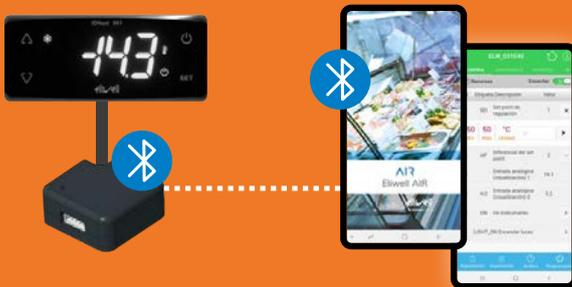
Eliwell AIR: Através do dongle Eliwell BLTE é possível utilizar o telemóvel e interagir com o comando para monitorização e colocação em funcionamento.
